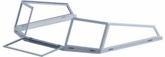
Neerklapbaar windscherm met verborgen scharnieren. Middenpaneel geklapt. (Onderbouw optioneel)
